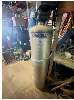
29. WATMAN VEDENSUODATIN, 110 LITRAA FeA sarjan suodattimet on suunniteltu raudan ja mangaanin sekä rikkivedyn poistoon humusvapaista vesistä.
